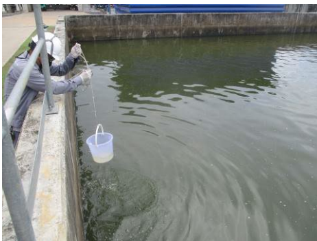
ภาพที่ 2-11 การตรวจวัดคุณภาพน้ำทั้งแบบครั้งคราว บริเวณจุดระบายน้ำทิ้งของโครงการ
