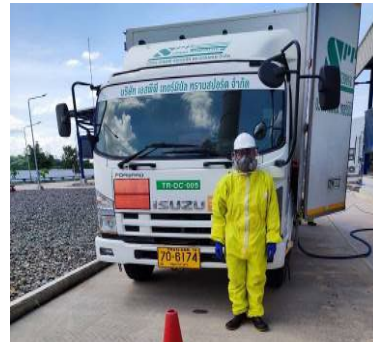
ภาพที่ 2-46 อุปกรณ์คุ้มครองความปลอดภัยส่วนบุคคลประจำรถ ขนส่งสารเคมีหรือวัตถุอันตราย
